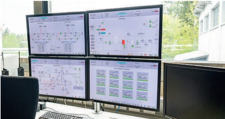
Der gesamte Prozess wird per Computer gesteuert und überwacht. Der Bildschirm unten rechts zeigt beispielsweise den Fortschritt in den Rekonditionierungsschränken an.
